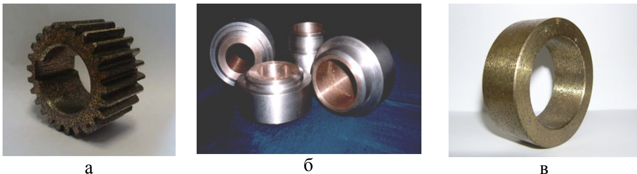
Рисунок 2. Изделия из литых композиционных материалов а) – шестерня, б) – биметаллическая втулка, в) – композиционная втулка для мобильной насосной станции
