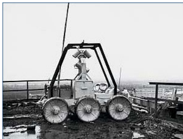
Робот СТР-1 выполнявший работы на кровле ЧАЭС
