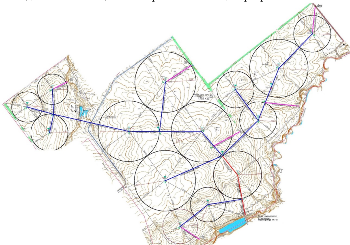
Рисунок 1. План расположения дождевальных машин на монтажном участке
